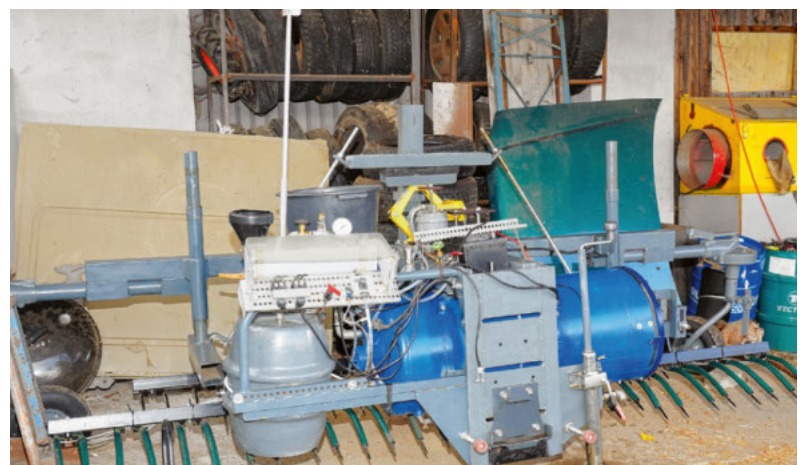
Tüftlerarbeit: Ein Prototyp ist dieses Gerät, mit dem man Komposttee und Demeter-Präparate als Aerosol ausbringen kann.
